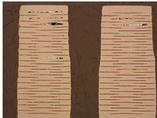
DPA : bad overlay ⇒ electrode shifting ⇒ shorts
